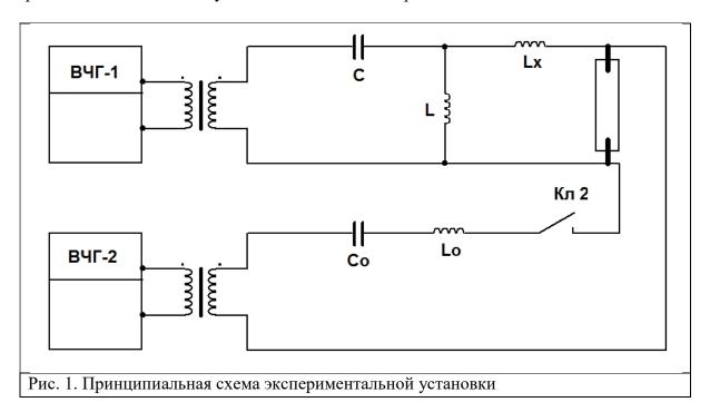
Для расчётов используем известную формулу:  $f_0 = \frac{1}{2\pi\sqrt{L_0C_0}}$ ,  $1 = 4\pi f_0^2 L_0C_0$ , и определяем  $4\pi f_0^2 L_0C_0 = 4\pi f_1^2 L_1C_0$ , где:
