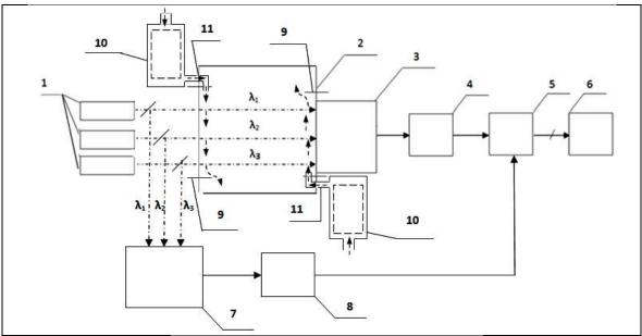
Рис. 1. Структурная схема системы непрерывного контроля аэрозольных выбросов на основе метода дифференциального ослабления на трёх длинах волн.
