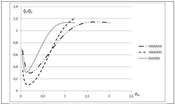
Рис. 3. Зависимость среднего объёмно-поверхностного диаметра от отношения усреднённых факторов эффективности на двух длинах волн
