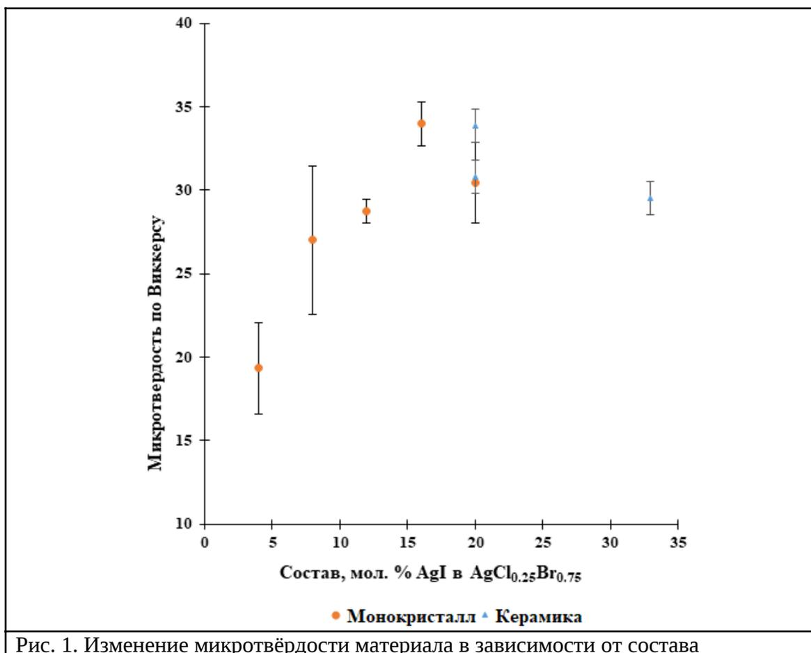
Рис. 1. Изменение микротвёрдости материала в зависимости от состава
