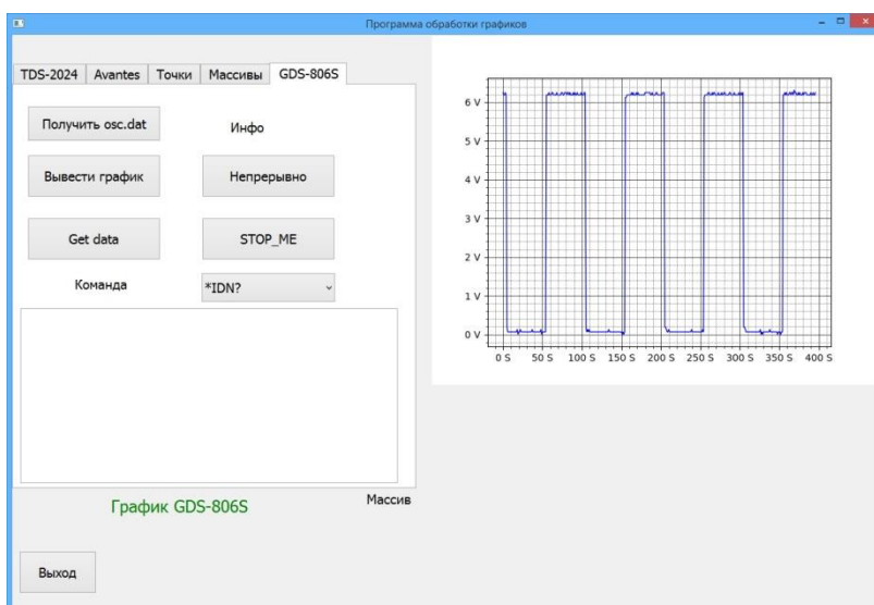
Рис. 7. Осциллограмма, полученная с осциллографа GDS806S по каналу RS232. Данные получены «как есть», без дополнительной обработки
