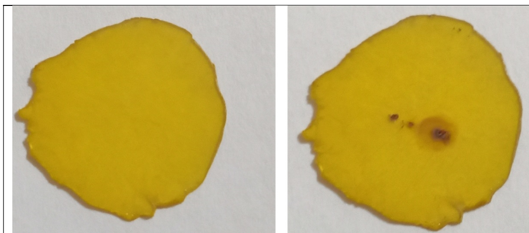
Рис. 1. Поверхность образца: слева – до разрушения, справа – после разрушения импульсами микросекундного диапазона.
